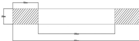
Gambar 1. Desain Sampel Uji Tarik (Tensile)
