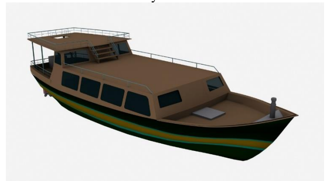
Gambar 2. Model 3D Kapal Pelayaran Rakyat Sesudah di Modifikasi
