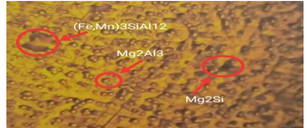
Gambar 9. Foto Mikro Daerah Weld Metal,
