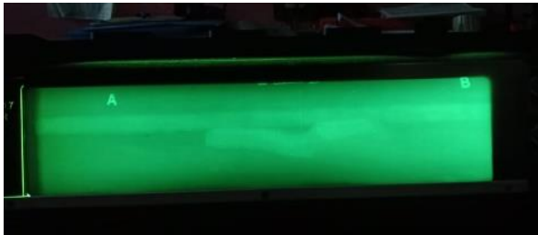
Gambar 8. Hasil Pengujian Radiography Pada 3x Pengelasan
