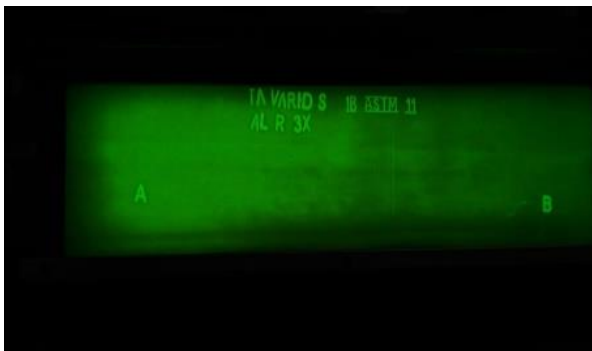
Gambar 9. Hasil Pengujian Radiography Pada 4x Pengelasan
