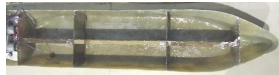
Gambar 6 Letak Tanki Ballast Dan Kompartemen.
