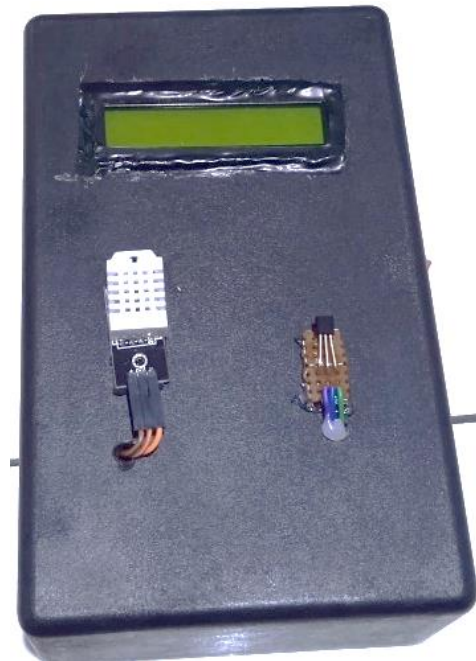
Gambar 4. Hasil perakitan alat pembaca suhu DHT22 dan LM35
