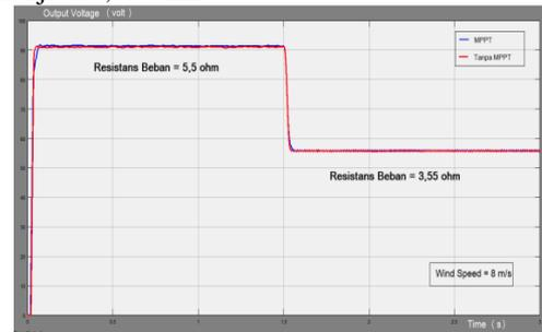
Gambar 15 grafik karakteristik tegangan turbin angin saat terjadi perubahan beban
