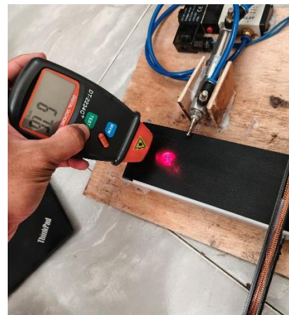
Gambar 6. Pengukuran RPM motor DC
