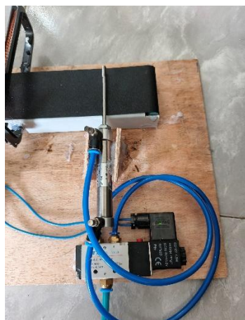
Gambar 8. Selenoid ON dan Pneumatik Maju
