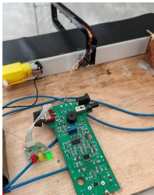
Gambar 4. Metal detector tidak mendeteksi logam
