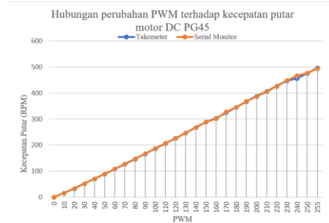
Gambar 10. Grafik hubungan perubahan PWM terhadap kecepatan putar motor DC PG45
