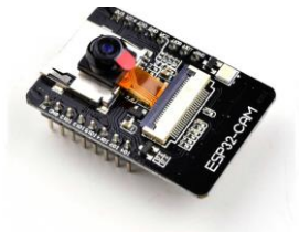
Gambar 1. ESP32 dan OV2640 sebagai pengambil gambar dan HTTP server.
