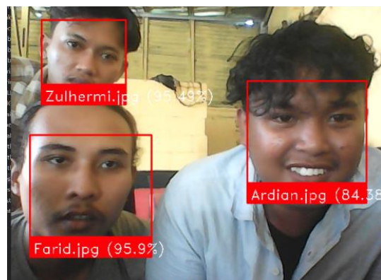
Gambar 6. Contoh deteksi dan identifikasi wajah dimana pada salah satu subjek tertutup sebagian oleh wajah subjek lain.
