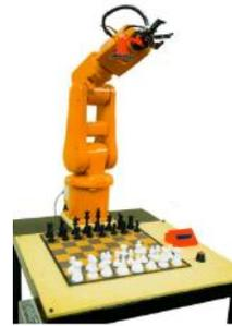
Gambar 3 Robot lengan 6 Dof Sebagai Robot Catur
