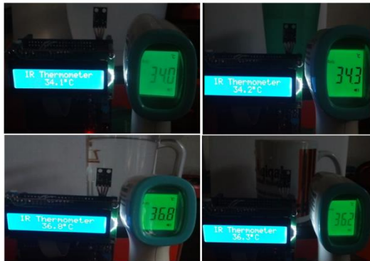
Gambar 3. Hasil Pengujian sensor pada jarak 5 cm
