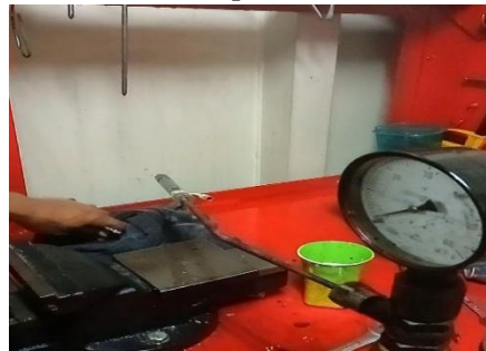
Gambar 4. Penurunan Tekanan Injeksi
