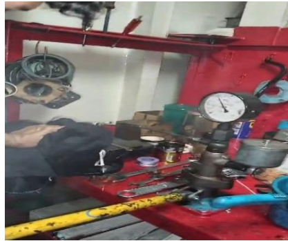
Gambar 7. Penyetelan Ulang Tekanan Injeksi
