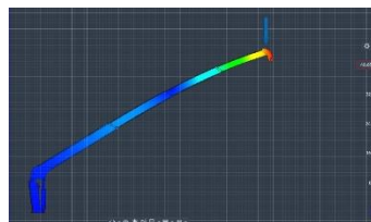
Gambar 3.2.11. simulasi deformasi dengan sudut 120^\circ dan beban 2,5 ton
