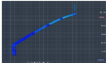
Gambar 3.1.10. simulasi von misses dengan sudut 120° dan beban 2 ton
