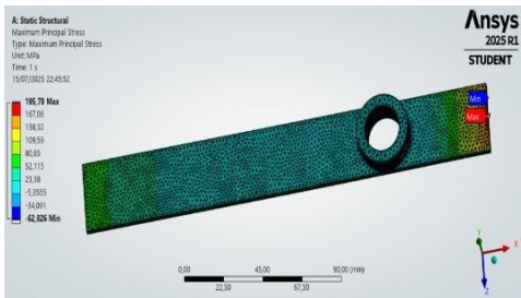
Gambar 3. Maksimum stress pada upper frame depan
