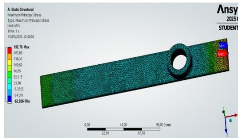
Gambar 3. Maksimum stress pada upper frame depan
