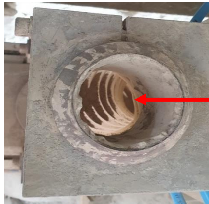
Gambar 4. Kondisi pipa jalur masuk material ke dalam Batch Extractor setelah dua minggu pemasangan tambahan Water Trap baru
