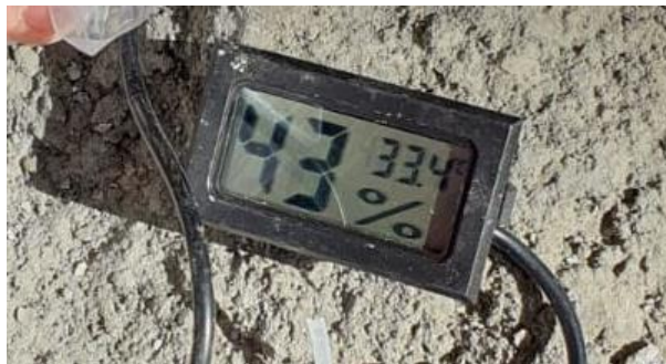
Gambar 6. Pengukuran kelembaban udara menggunakan Hygrometer sesudah penambahan jumlah Water Trap baru
