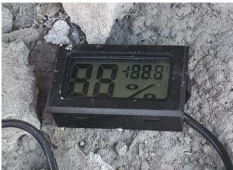
Gambar 5. Pengukuran kelembaban udara menggunakan Hygrometer sebelum penambahan jumlah Water Trap baru
