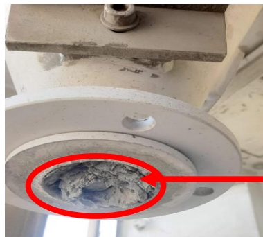
Gambar 1. Kondisi Outlet Mixer Material Storage sebelum Pemasangan Tambahan Water Trap Baru
