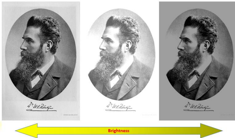
Gambar 2: Window Level (WL). kiri, tampak lebih terang; tengah, gambar asal; kanan, tampak lebih gelap 12 .
