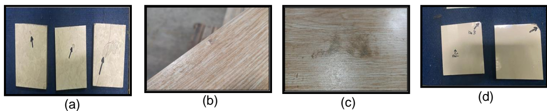
Gambar 1. Hasil Pengecekan Kualitas Granit Kategori Reject (a) Retak (b) Krowling/Mengelupas (c) Kotor Kiln (d) Sompel Transportasi
