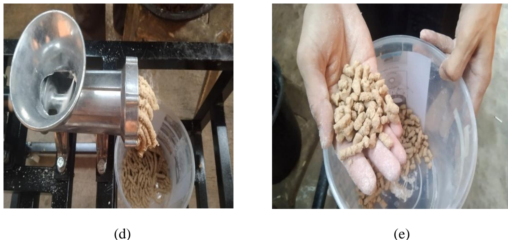
Gambar 7. Pengetesan Alat Produksi Pakan Ikan (a) alat dan bahan (b) pengadonan bahan (c) pengisian adonan kedalam wadah pencetakan (d) setelah pengisian adonan (e) hasil produksi
