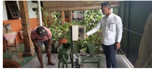
Gambar 4. Mengoperasikan Alat Pembuat dan Penghalus Pupuk Kandang
