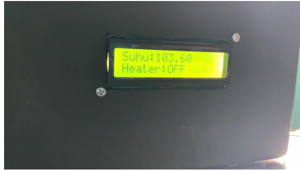
Gambar 15. Temperatur Suhu di atas 60, Heater OFF
