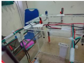
Pengujian Sensor LM35 Pada Kamar 1
