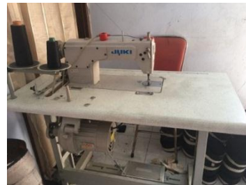
Gambar 11 Mesin Jahit Merk Juki Tipe DDL-8100E dan Serah Terima Alat Produksi
