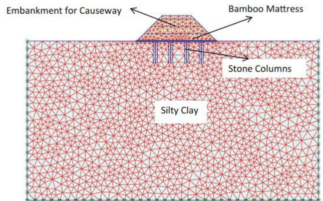
Gambar 4. finite element method (FEM) model untuk timbunan dengan *stone column* dan matras bambu (Arsyad et al., 2019)
