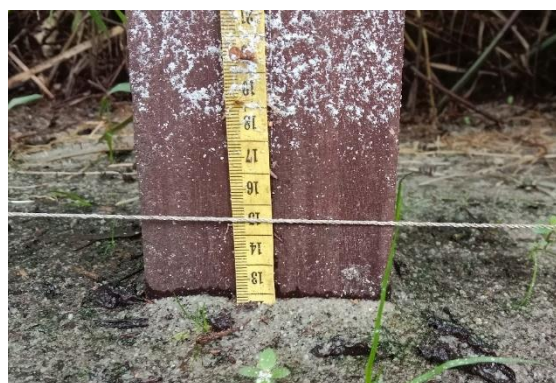
Gambar 8. Pembacaan Penurunan di Laboratorium Sumber: Hasil Analisis (2025)
