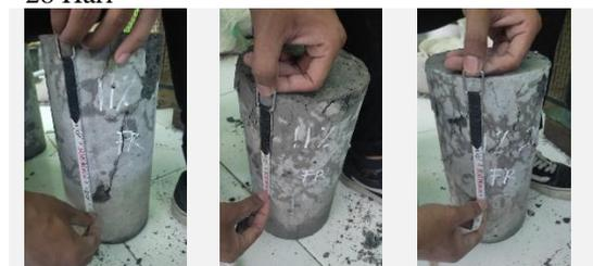
Gambar 7. Proses pengujian keretakan pada benda uji silinder umur 28 hari
