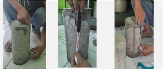
Pengujian Keretakan Beton Variasi 7% Umur 14 Hari
