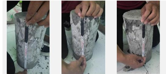
Pengujian Keretakan Beton Variasi 9% Umur 28 Hari
