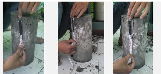
Gambar 5. Proses pengujian keretakan pada benda uji silinder umur 14 hari
