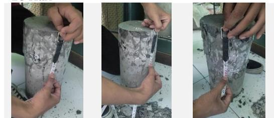
Pengujian Keretakan Beton Variasi 11% Umur 28 Hari
