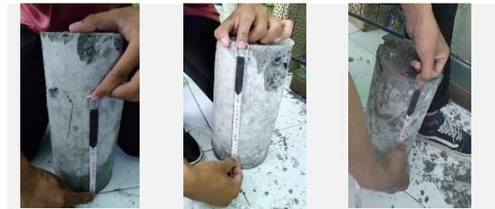
Pengujian Keretakan Beton Variasi 7% Umur 28 Hari
