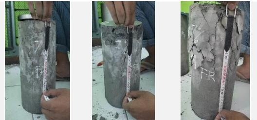
Pengujian Keretakan Beton Variasi 9% Umur 14 Hari
