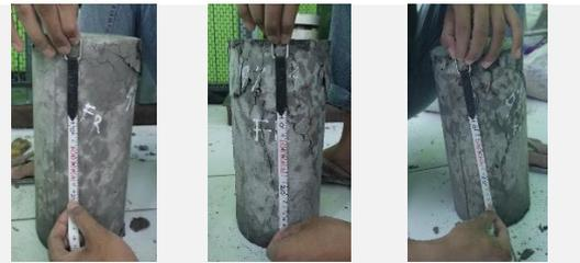
Pengujian Keretakan Beton Variasi 11% Umur 14 Hari
