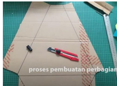
Gambar 5. Pembuatan pola dasar cangkang plat lipat ruang Sumber: Dokumentasi Studio Struktur 2020
