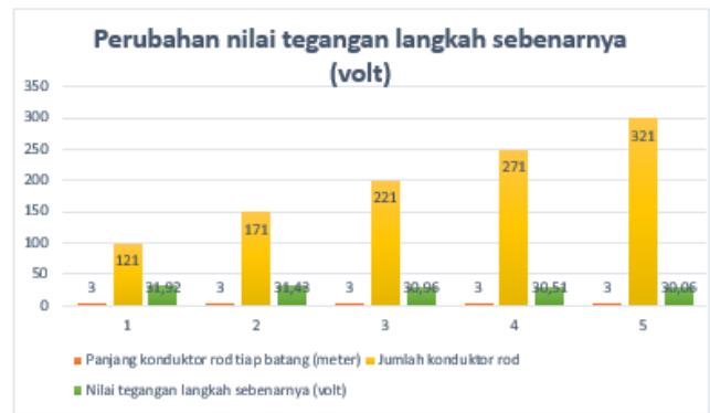
Gambar 5. Grafik perubahan jumlah konduktor rod terhadap nilai tegangan langkah sebenarnya
