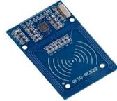
**Gambar: 2 Module RFID RC522**
