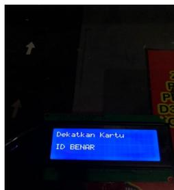
**Gambar 16. Pengujian LCD Jika Identitas Benar**
